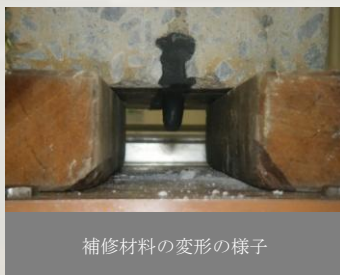
補修材料の破壊直後の様子
