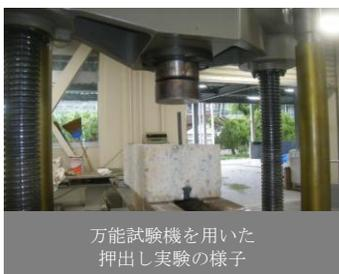
万能試験機を用いた押し実験の様子
